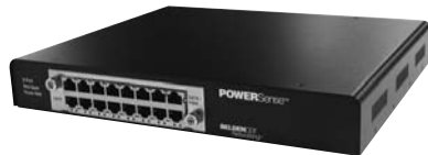
PowerSense Midspan-Hub gemäß IEEE 802.3af mit 8 Ports
